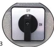
3. Llave de alimentación del compresor · 4. Botón de marcha/parada
