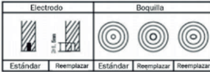
n. / Necesidad de cambiar la boquilla del electrodo de la antorcha
